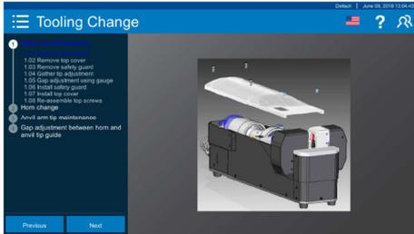
Pilotée par écran tactile de 22 pouces, la nouvelle interface graphique permet d'afficher clairement l'ensemble des informations pendant la soudure et affiche en temps réel les valeurs critiques.
